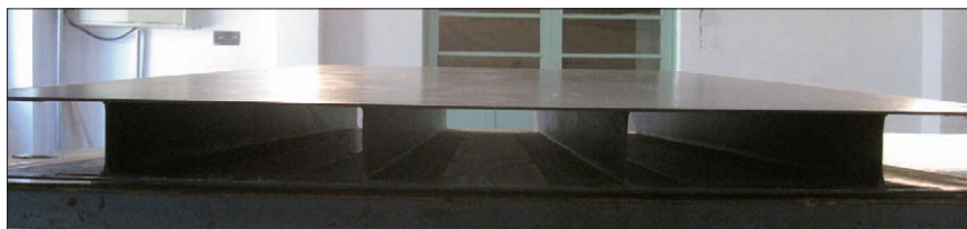
图3 国内采用骨架与上下蒙皮一体成型工艺研制的盒段件
