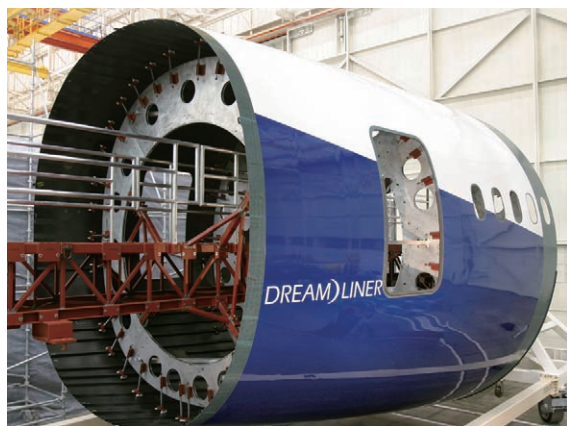
图4 一体成型的波音787机身段
